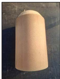
รูปที่ 2-12 ตัวอย่างลักษณะ Foam PIG และ Foam PIG ที่ผ่านการใช้งานทดสอบด้วยวิธีชลสถิต
