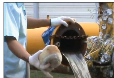
รูปที่ 2-12 ตัวอย่างลักษณะ Foam PIG และ Foam PIG ที่ผ่านการใช้งานทดสอบด้วยวิธีชลสถิต
