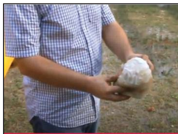
รูปที่ 2-12 ตัวอย่างลักษณะ Foam PIG และ Foam PIG ที่ผ่านการใช้งานทดสอบด้วยวิธีชลสถิต
